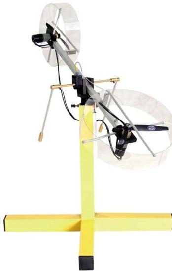
两个转子空气动力学系统（TRAS）是一个为控制实验设计的装置。在某些方面，其行为类似于直升机。从控制的角度来看，它举例说明了具有显著交叉耦合的高阶非线性系统。TRAS 由在其基座上枢转的梁构成，使得梁能够在水平和垂直平面中自由旋转。在梁的两端有直流电机驱动的转子（主和尾）。在其端部具有配重的平衡臂在枢轴处固定到梁上。梁的状态由四个过程变量描述：由安装在枢轴处的编码器测量的水平角和垂直角以及两个对应的角速度。两个附加状态变量是由与驱动直流电动机耦合的速度传感器测量的转子的角速度。在真实的直升机中，空气动力通过改变螺旋桨的迎角来控制。在实验室设置中，迎角是固定的。空气动力通过改变转子的速度来控制。在转子之间的相互作用观察到显著的交叉耦合。每个转子影响两个位置角度。TRAS 稳定控制器的设计基于去耦合。
