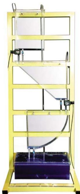
控制的总体目标是通过调节泵操作或/和阀设置来达到并稳定罐中的液位。该控制问题可以通过从 PID 到自适应和模糊逻辑的多种电平控制策略来解决。
