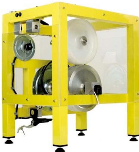
有两个编码器测量两个车轮的旋转角度。在实验开始时，模拟相对道路运动的车轮被加速到假定的阈值速度。如果达到阈值速度，则开始制动程序。如果车轮变得不动，则意味着它保持滑动运动（车速不等于零）或者它被绝对停止。滑移越小，车辆控制越好。可以应用预编程的滑动控制算法之一。该实验的结果显示在下面的图中。
